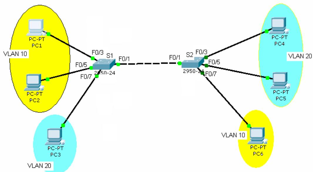
Koristeći tablicu IP adresa potrebno je konfigurirati navedene računala i VLAN-ove, a nakon toga pinganjem potvrditi da se promet unutar VLAN-ova može nesmetano odvijati.
