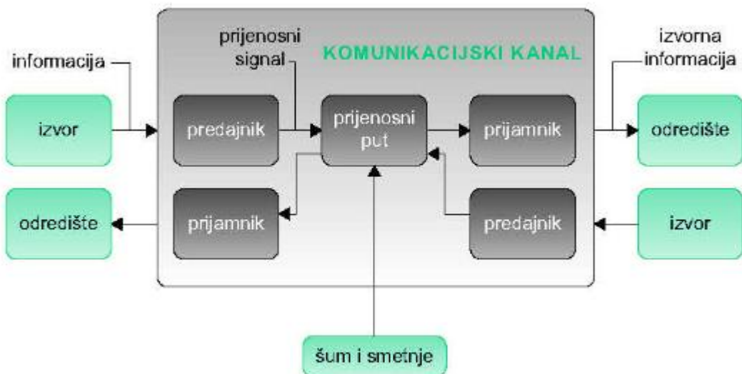
Slika 1.2. Blokvska shema poludvosmjernog komunikacijskog sustava
